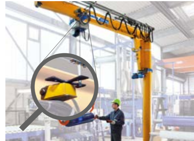
Grenzschalter Katzfahren (Bild 8)
