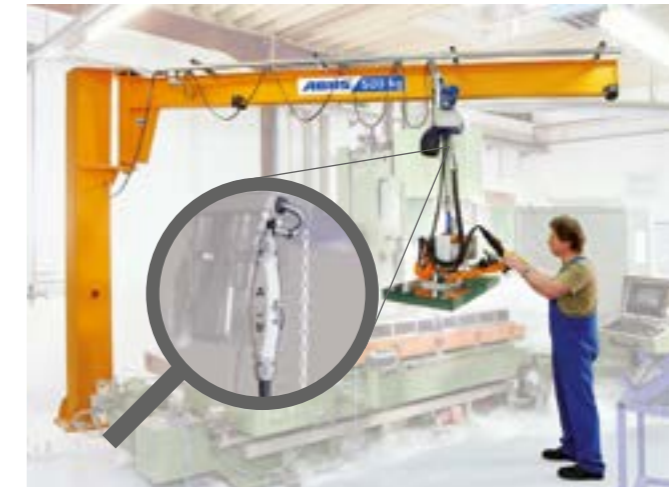
Schwenkkrane mit Vakuumgerät u. Stecker (Bild 13)
