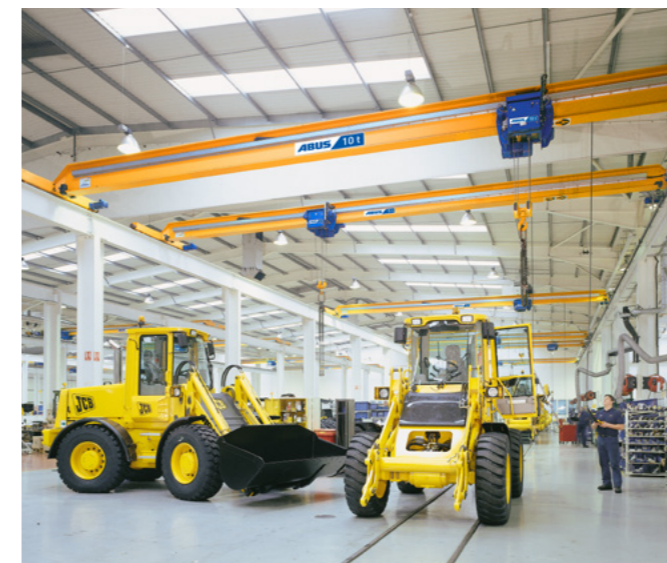
Einschielenlaufkatzen der Bauart E an Einträgerlaufkränen ELV
